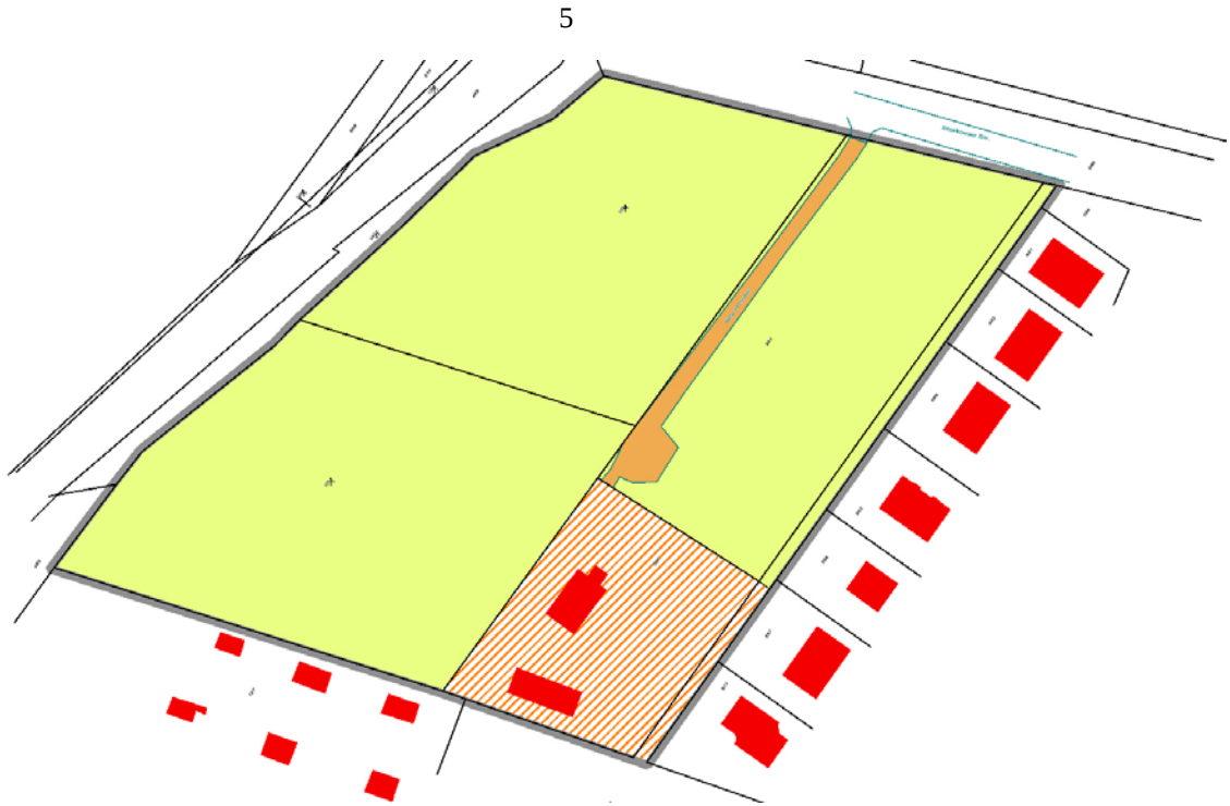
Bild – Bestand im Plangebiet (rot = Gebäude, grau = Bitumenflächen, braun = Schotterfläche, Grün = Wiesenfläche, schraffiert = Eigenheimgrundstück mit Wohngebäude und Nebenanlagen – Wege, Carport, Flächenbefestigungen)
