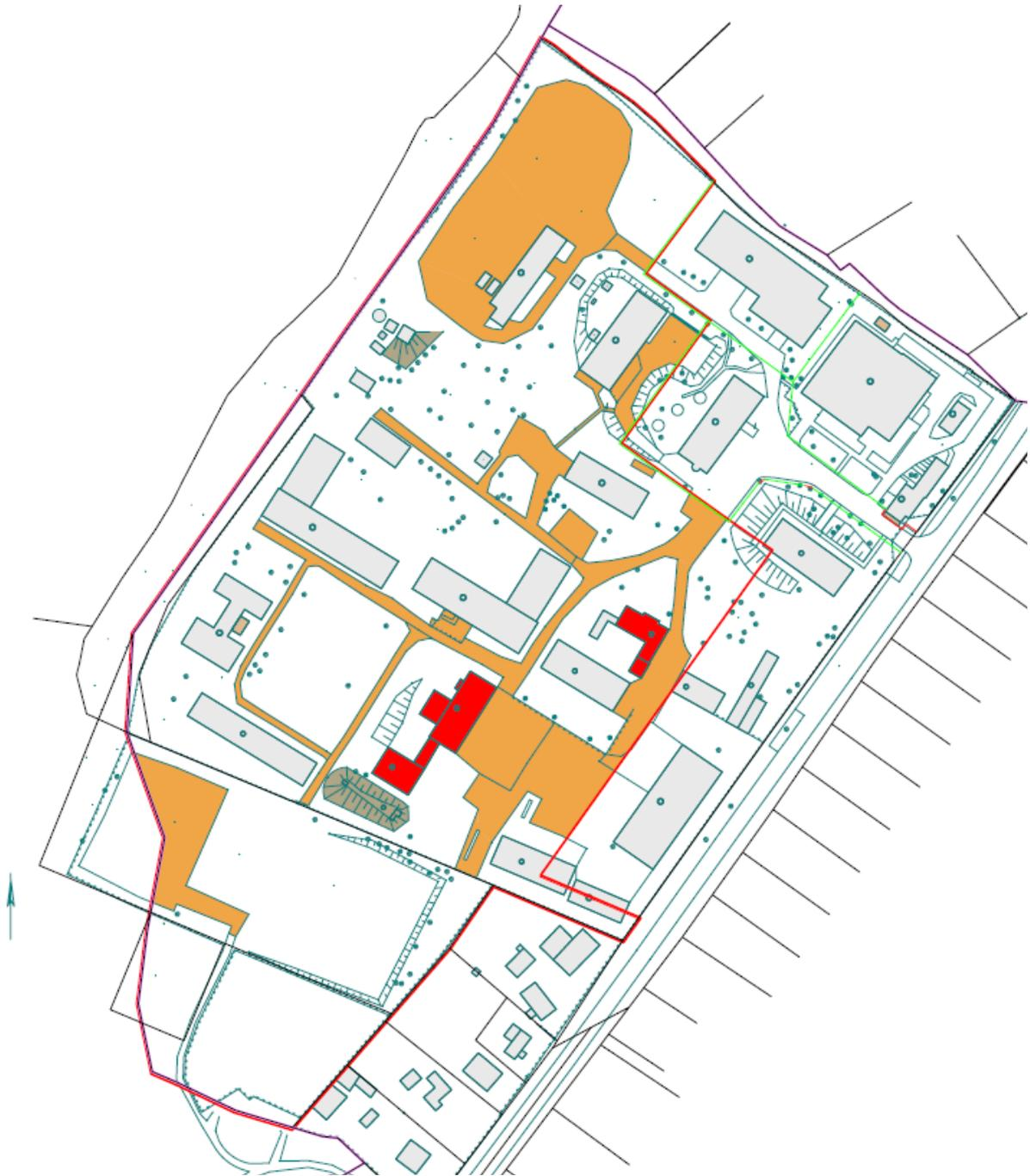
Bild – Bestand im Plangebiet lt. Vermessung (hellgrau = Gebäude, rot = unter Denkmalschutz stehende Gebäude, braun = Flächenbefestigungen, dunkelgrau = Bunkeranlagen, Aufschüttungen) Darüber hinaus ist insbesondere im Bereich der Gebäudeeingänge mit weiteren versiegelten Flächen zu rechnen.
