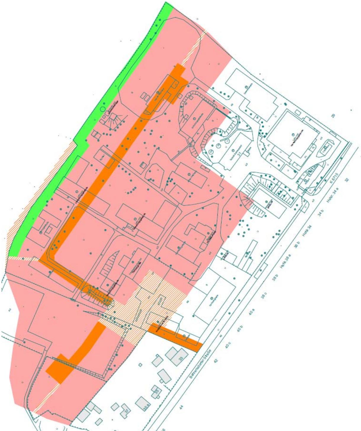
Bild – geplante Verkehrserschließung abgehend von der vorhandenen Bahrendorfer Straße = braune Fläche, schraffierte Fläche = Verkehrsfläche besonderer Zweckbestimmung, rot = geplante Wohnbaufläche
